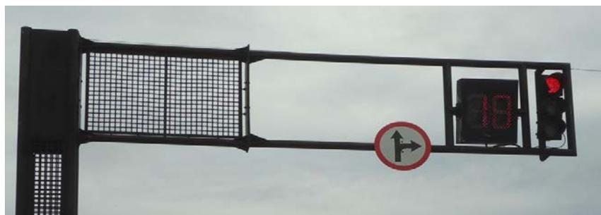
**Figura 2.9:** Temporizador com display eletrônico de *LED*
