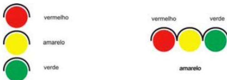
**Figura 2.5:** Disposição da sequência luminosa do semáforo
