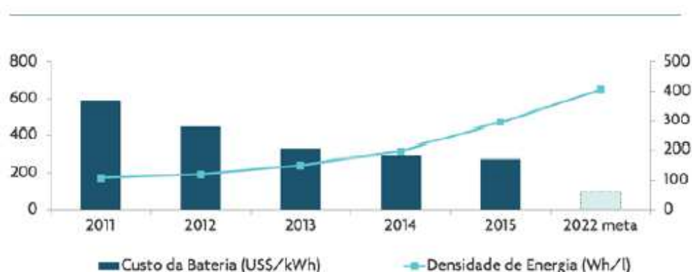
Figura 2-4: Evolução de custo e densidade energética da tecnologia de bateria para veículos elétricos.
