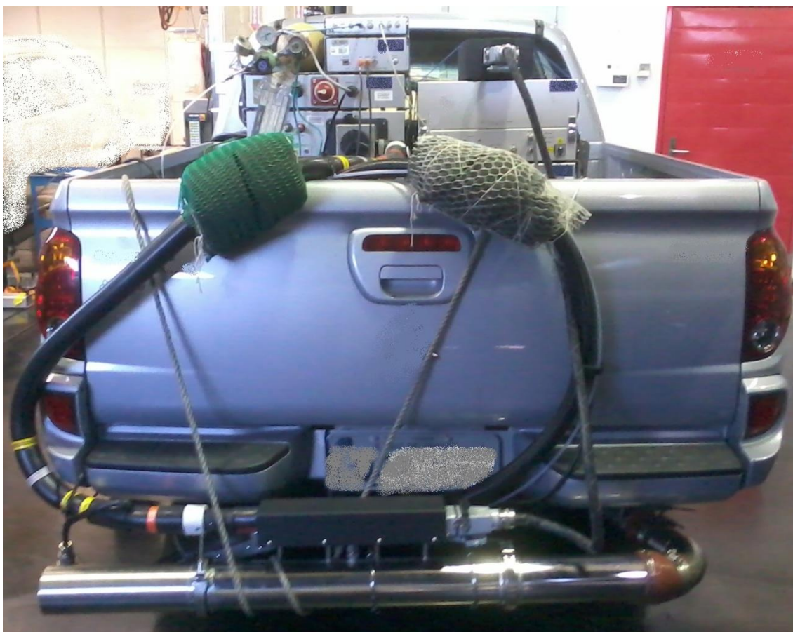
Figura 7: Equipamento PEMS montado em um veículo.
