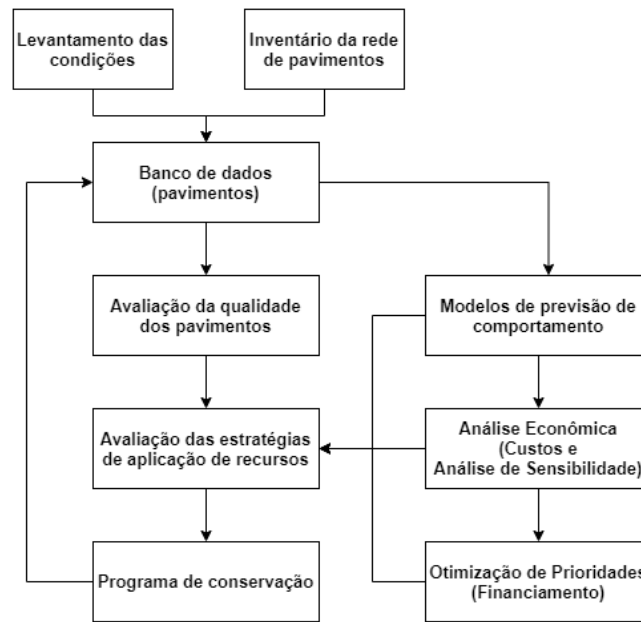
Figura 9 – Estrutura de um SGPA (ANAC, 2017)
