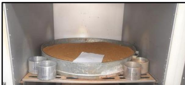
Figura 26: Cápsulas de alumínio e bandeja com solo para secagem em estufa a 100°C
