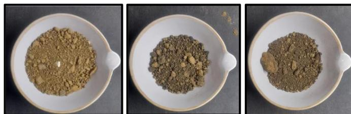
Figura 34: I (solo), II (solo + água+ emulsão + água de diluição) e III (solo+ emulsão diluída)
