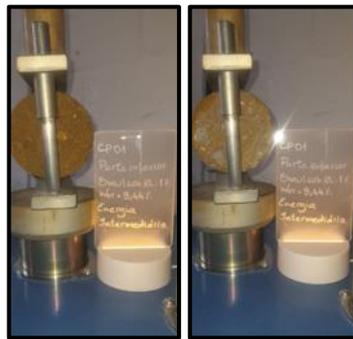
Figura 42: CPs cortados na multiprensa
