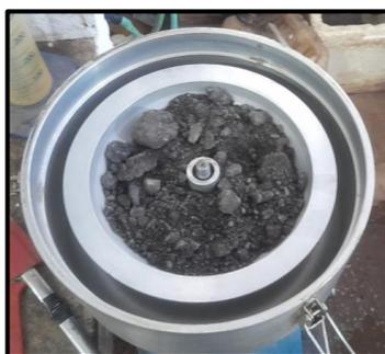
Figura 28: Rotarex e fresado asfáltico
