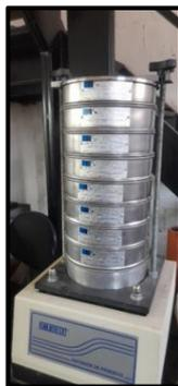
Figura 21: Peneirador elétrico da Soloteste
