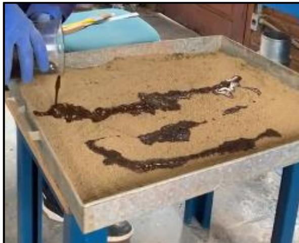
Figura 37: Homogeneização do solo com emulsão asfáltica
