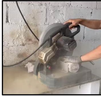
Figura 41: Serra elétrica cortando o CP
