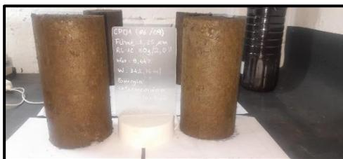
Figura 38: CPs estabilizados com emulsão asfáltica
