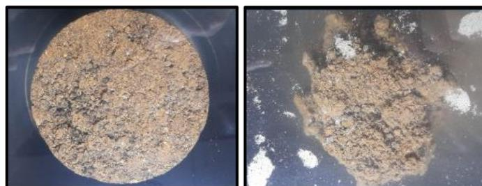
Figura 35: Solo imerso em água por 24h (1h de ensaio)
