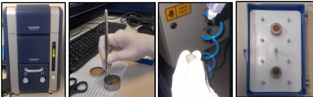
Figura 30:Preparação da amostra de solo para análise no MEV/EDS
