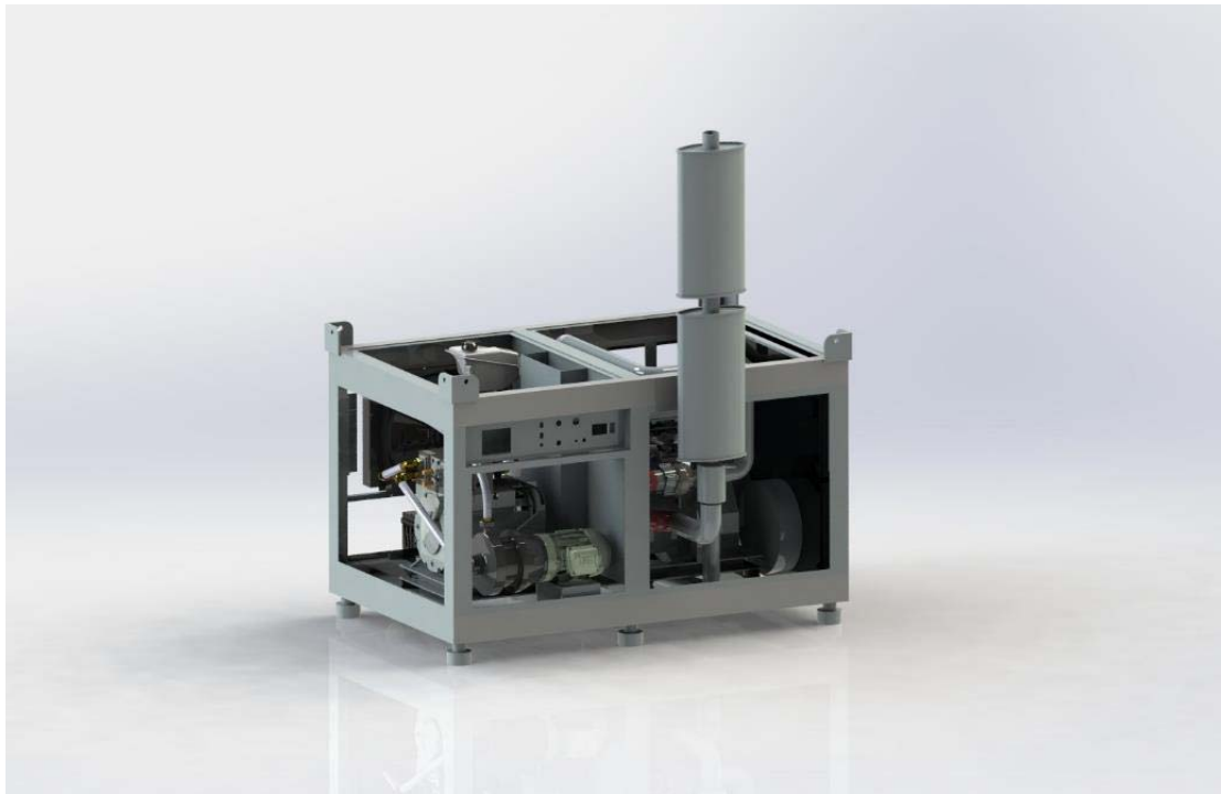
Figura 21 – Renderização do sistema CESE-Etanol em vista em perspectiva, em modo estacionário
