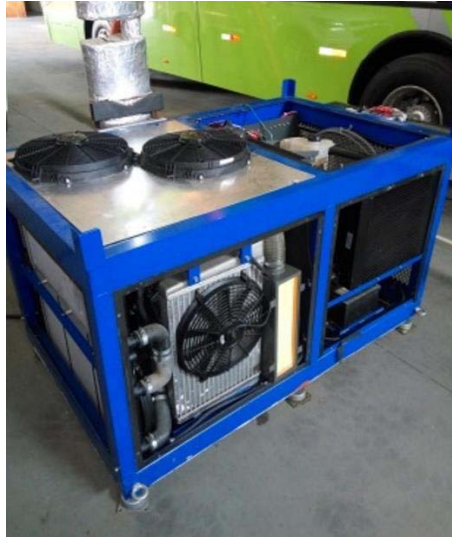
Figura 23 – Registro fotográfico do CESE-Etanol fabricado em modo estacionário
