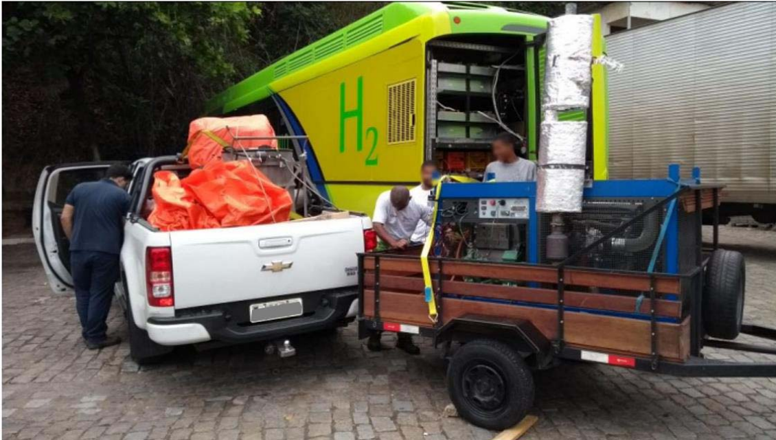
Figura 26 – Ônibus Híbrido Elétrico Hidrogênio sendo recarregado pelo CESE-Etanol em um teste de campo. (Fonte da Imagem: Adaptado de COPPETEC, 2018)
