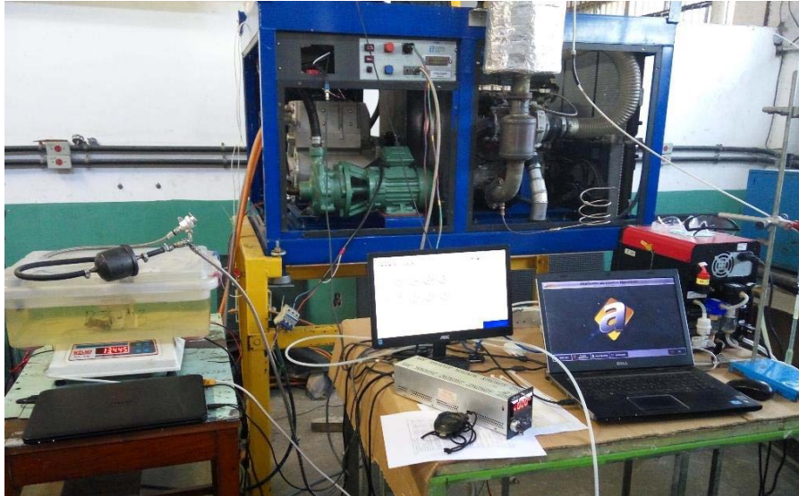
Figura 25 – Fotografia da montagem do aparato experimental para medições no CESE-Etanol em modo estacionário (Fonte: Elaboração própria).
