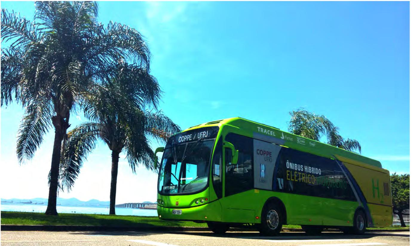
**Ônibus da UFRJ, produzido pelo Laboratório de Hidrogênio (LabH2), equipado com um motor híbrido movido a hidrogênio e eletricidade**
