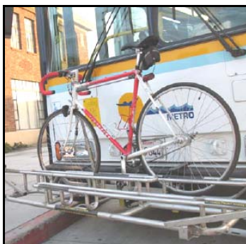
Figura 4.14: Sistema de rack para bicicletas nos ônibus, Estados Unidos.
