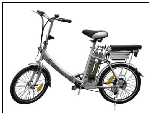
Figura 2.6: Bicicleta híbrida com célula combustível de hidrogênio. Fonte: < www.pearlhydrogen.com >, 2009.
