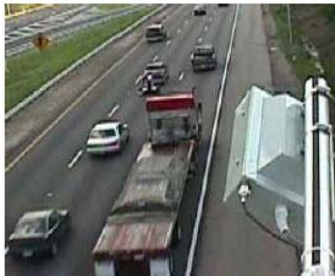
Figura 2.16 - Exemplo de sensor acústico montado na lateral da via
