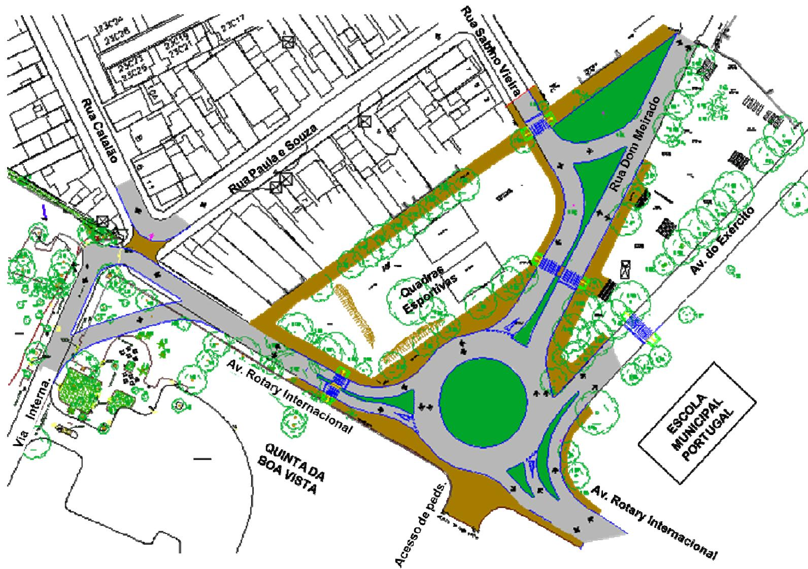
Figura 4.7 – Dimensionamento Final da Rótula Projetada na Interseção
