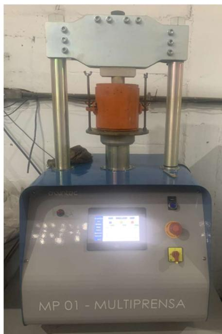
Figura 17 – Prensa utilizada para a penetração
