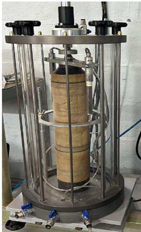
Figura 19 – Corpo de Prova envolto por membrana látex, no equipamento triaxial
