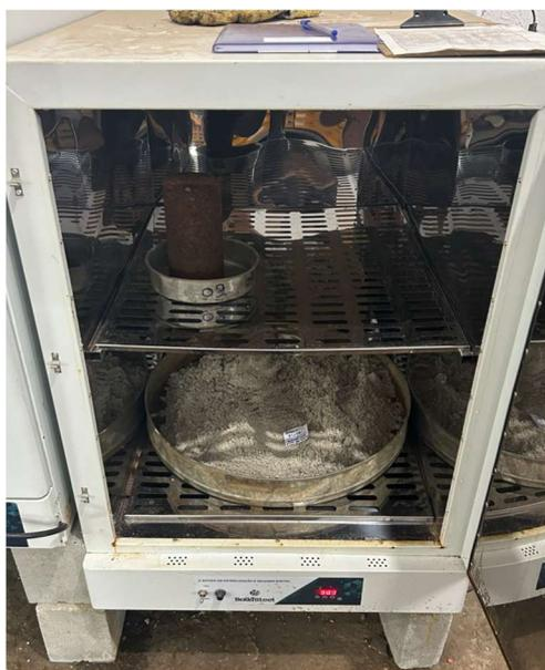
Figura 11 – Estufa utilizada para Secagem de materiais
