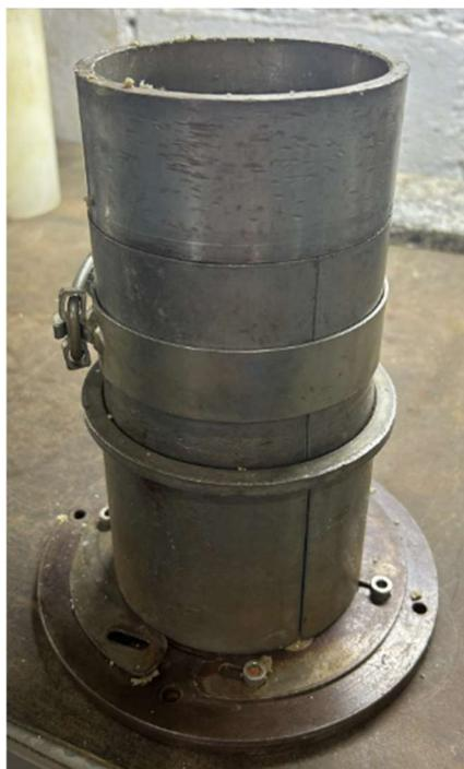
Figura 14 – Cilindro Tripartido de 10 cm de diâmetro
