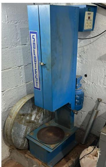
Figura 13 – Equipamento Mecânico de Compactação
