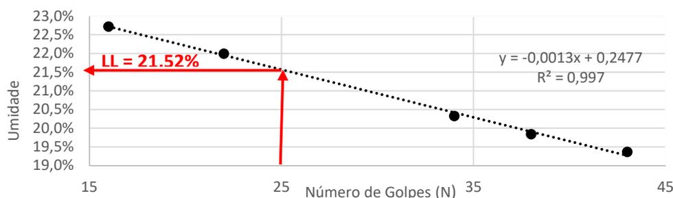
Figura 22 – Resultados do Ensaio de Limite de Liquidez do rejeito de minério de ferro
