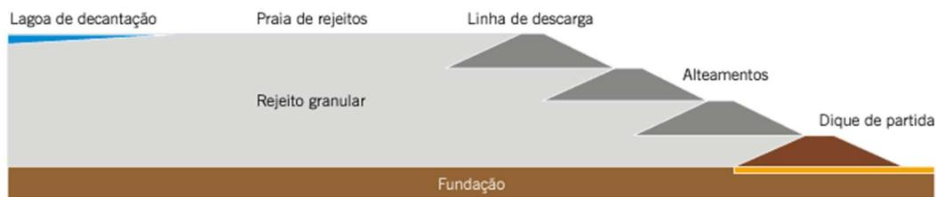
Figura 4 – Método à Montante de Barragem (IBRAM, 2016)
