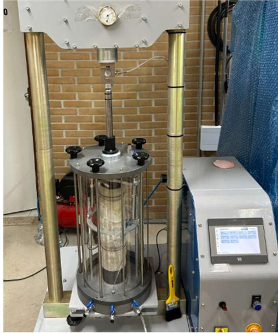
Figura 18 – Equipamento triaxial para aplicação cíclica de cargas
