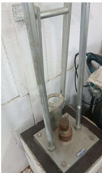
Figura 12 – Modelo do Aparelho de Compactação Mini-MCV
