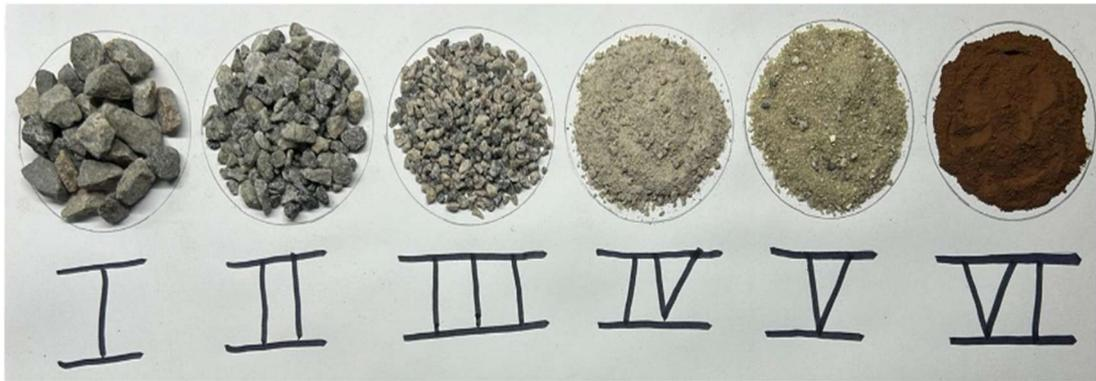
Figura 20 – Agregados utilizados no Estudo. (I) Brita 1 (II) Brita 0 (III) Areia Grossa (IV) Pó de Pedra (V) Areia Média (VI) Rejeito de Minério de Ferro
