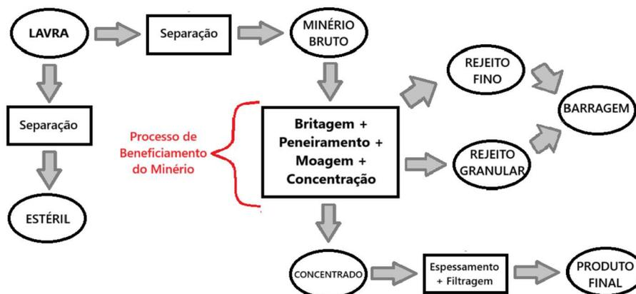
Figura 1 – Fluxograma simplificado do processo de mineração (Adaptado de MELKI, 2021)
